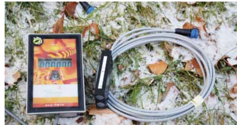
Das im Naturpark Kyffhäuser eingesetzte Zählgerät „Eco twin logger“ der Firma Eco-Counter
